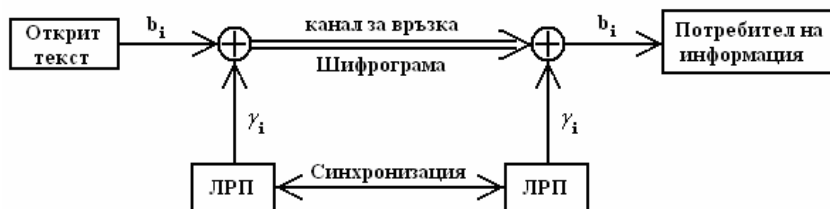
Фиг.5: Структура на КИС, в която информацията се шифрира с помощта на ЛРП
