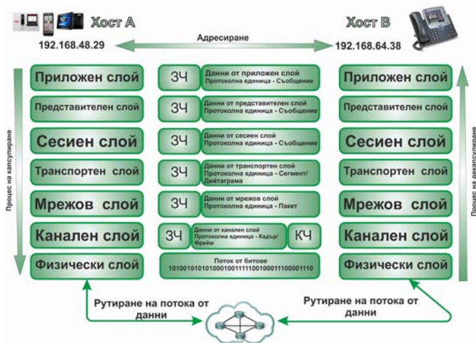
Фиг. 2.1. Основните процеси на адресиране, капсулиране, рутинане и декапсулиране на потока от данни между двете крайни устройства
