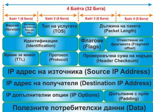
Фиг. 1.1. Пакетен хедър (заглавна част) на протокола IPv4
