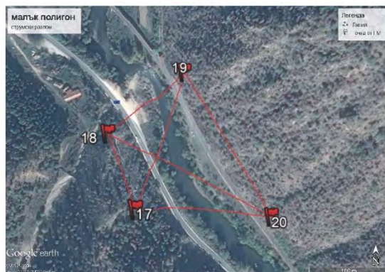
Фиг.2 Схема на полигон на Струмски разлом M_1
