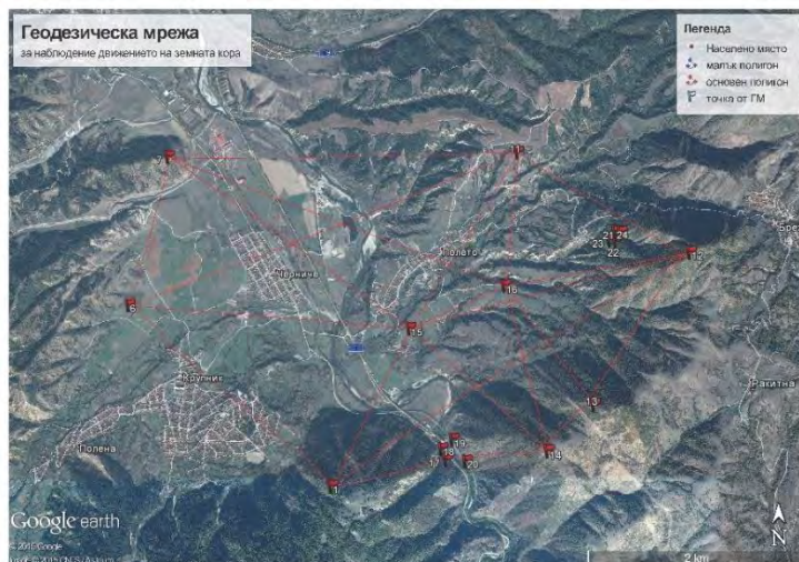
Фиг.1 Схема на геодезическата мрежа предназначена за наблюдение на движението на земната
