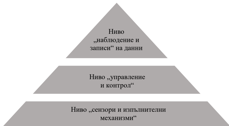
Фиг.1 Структурата на системите за технологичен контрол и управление.
